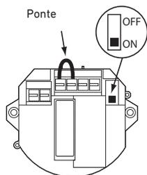
Prima della messa in funzione portare l'interruttore della batteria in posizione «ON».
