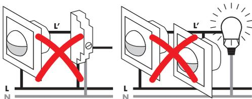
L'apparecchio non è stato concepito per l'impiego sulle minuterie elettroniche e/o su relè/contattori. Si sconsiglia il collegamento in parallelo di più rilevatori di movimento e/o rilevatori di movimento e interruttori.
