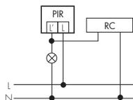
Per un funzionamento, Indoor 180 Kombi 2L necessita di un carico minimo di circa 40 W. In presenza di carichi piccoli o nel collegamento di lampade LED o FL può rendersi necessario l'utilizzo di un filtro RC.
